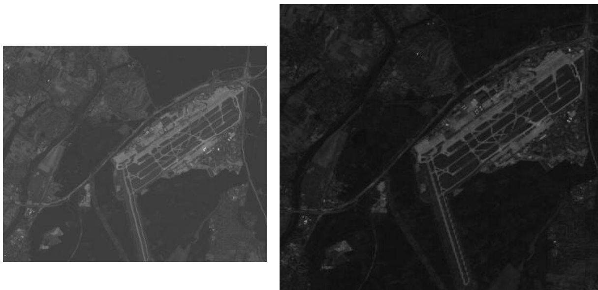
Abb.4 Ausschnitt aus Referenz- und transformiertem Bild für eine Referenzierung von multisensoralen Bildern
