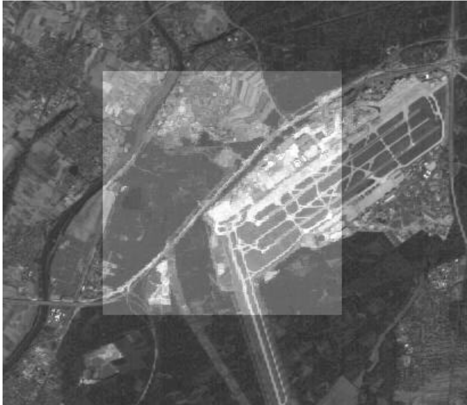
Abb.5 Ausschnittkomposit des Transformationsergebnisses außen: Referenz (IRS, Oktober 97) innen: Transformiertes Bild (TM, September 97)
