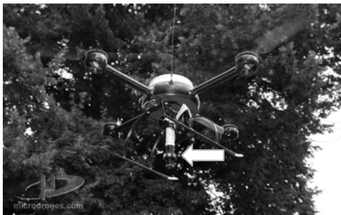
Abb. 2: MD4-200 mit Minirundprisma
